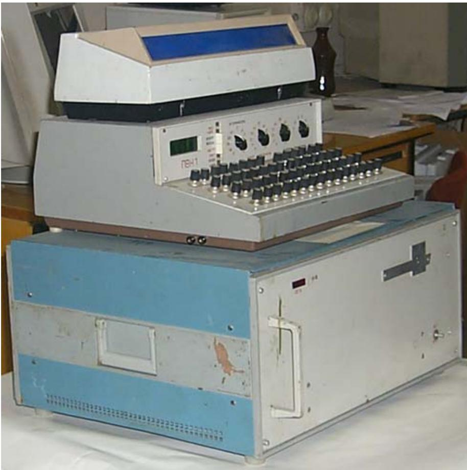
**Рис. 5. Общий вид отечественного нейрокомпьютера 1974 г. Размерность входного пространства признаков 30. Количество распознаваемых классов 8.**
