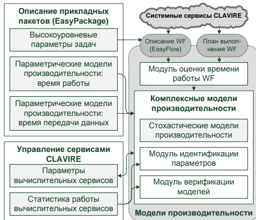
Рис. 1. Программная система для оценки производительности облачной инфраструктуры на базе платформы CLAVIRE
