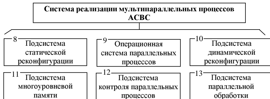
Рис.2. Состав функциональных подсистем реализации мультипараллельных процессов АСВС Основные проблемы теории и технологий синтеза Адаптивных Самоорганизующихся Вычислительных Систем представляет рис.3.
