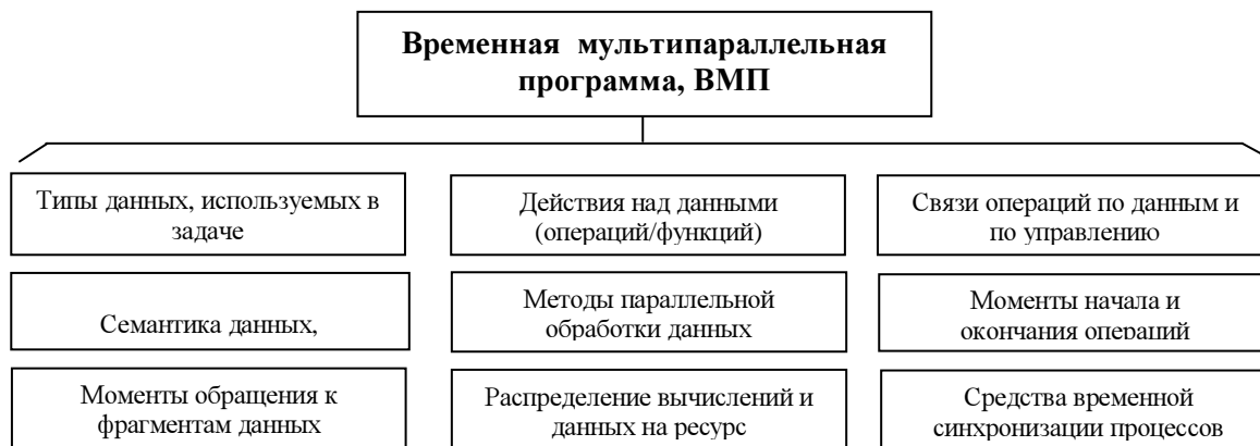
Рис.6. Категории информации времяпараметризованных мультипараллельных программ
