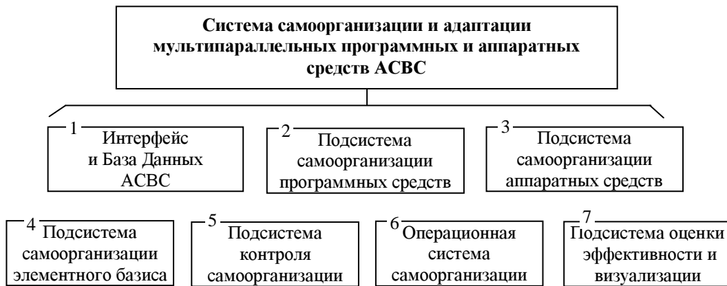
Рис.1. Состав функциональных подсистем самоорганизации и адаптации параллельных программных и аппаратных средств АСВС
