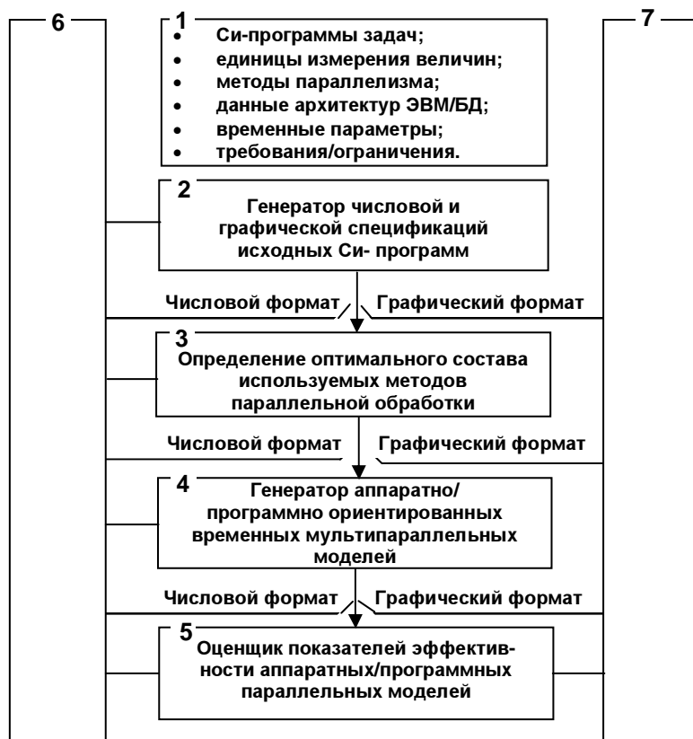
Рис 7. Архитектура технологии автоматического синтеза временных мультипараллельных моделей задач СПМ
