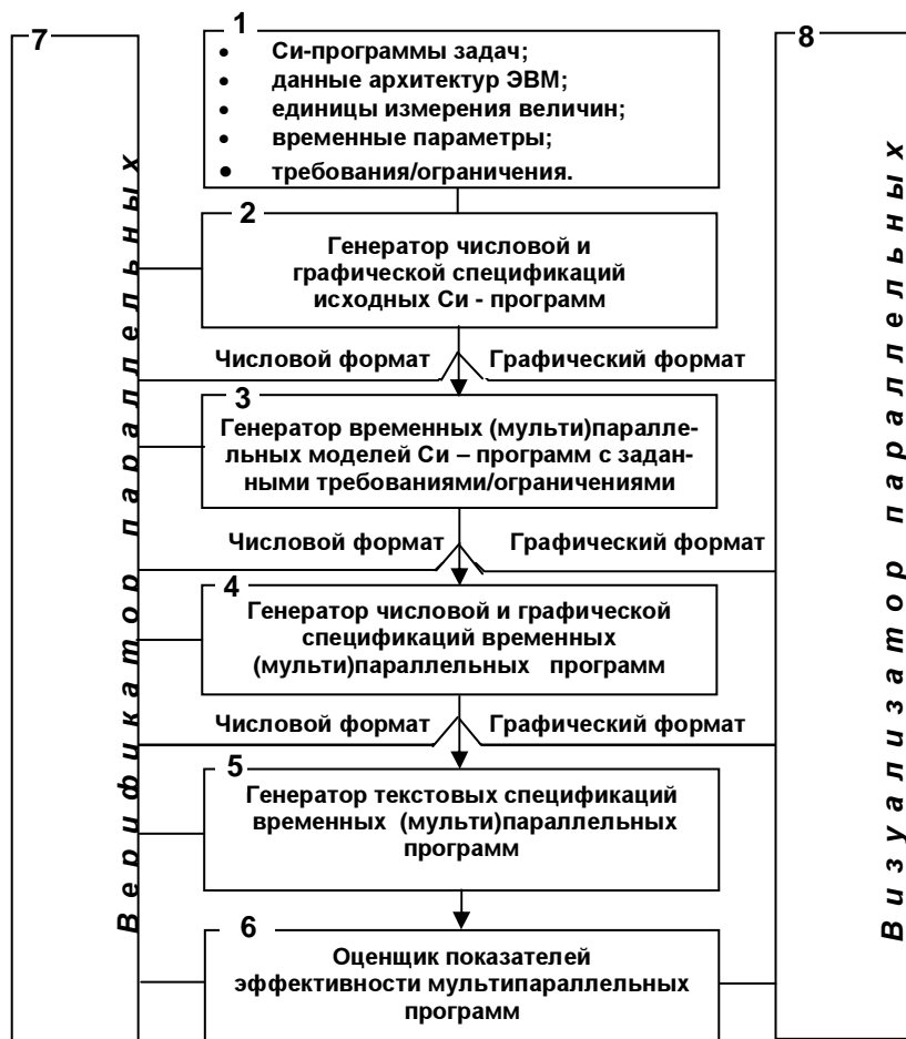
Рис. 8. Архитектура адаптивной технологии автоматического проектирования параллельного программного обеспечения (ПИК)
